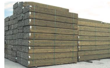
El poliéster (PET) es el fleje elegido para la madera tratada a presión gracias a sus características de elongación y recuperación. Las cargas de madera se unifican antes del tratamiento. El fleje de PET no se corroe por los productos químicos del tratamiento, a diferencia del fleje de acero que puede oxidarse y manchar la madera.
